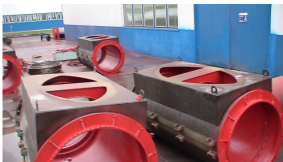
Рис.5. Конструкция колодца КТ в разборе
